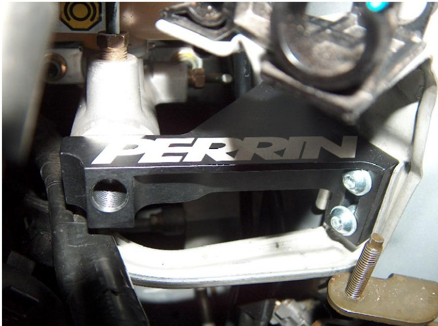
Maintenant que la cale est en place, vous pouvez remonter le gros boulon doré de réglage et le visser fermement sur le maître-cylindre (clé Allen de 6 mm). Ensuite, vous vissez le contre-écrou de blocage (douille de 19 mm) fermement.
